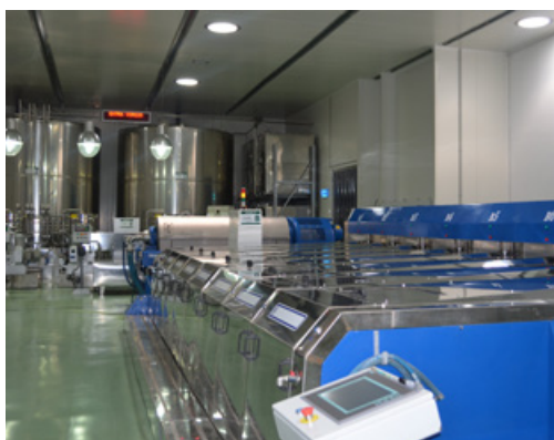
Το σχολαστικό πλύσιμο του ελαιόκαρπου πριν την έκθλιψη συμβάλει θετικά στην ποιότητα του ελαιόλαδου που θα παραχθεί. (πάνω) Με τη χρήση μαλακτών κλειστού τύπου αποφεύγεται η παρατεταμένη επαφή της ελαιόπαστας με τον αέρα και η υποβάθμιση της ποιότητας του ελαιόλαδου. (κάτω)
