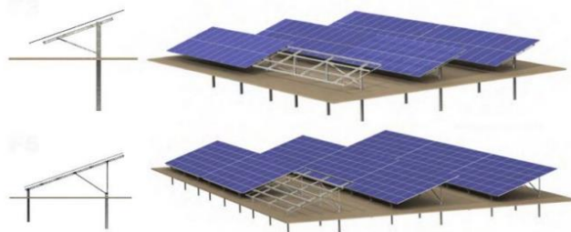
Εικόνα 6.4: Έδραση Φωτοβολταϊκών πλαισίων με τη μέθοδο πασσαλόμπηξης.
